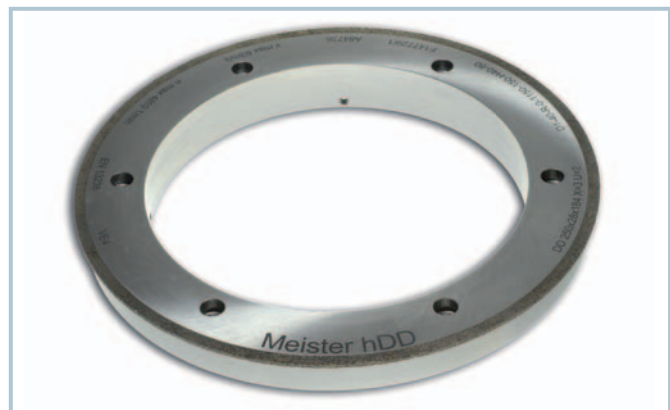
5 Das Abrichten von Außenrundscheifscheiben mit dem hDD-Abrichtwerkzeug DD120×12×40 X=5 W=2 D42-426-175-H* erbrachte eine Verkürzung der Prozessdauer um 30 Prozent
