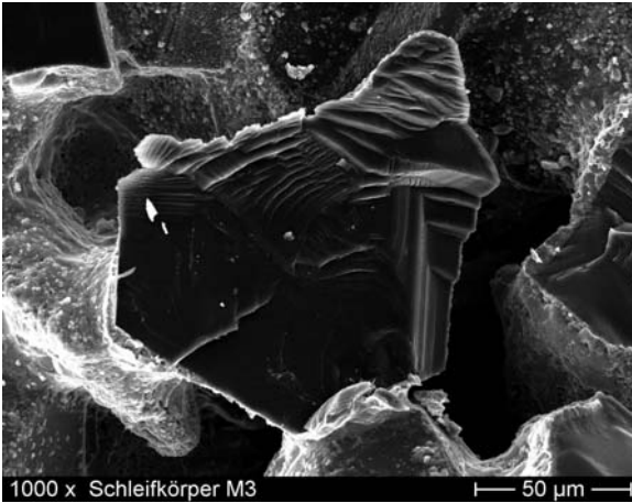
3 Der Bruch einer hDD-Struktur ist in der Regel mit einem Splittern des Diamantkorns verbunden, nicht aber mit Delaminationen an den Grenzflächen Matrix/Korn
