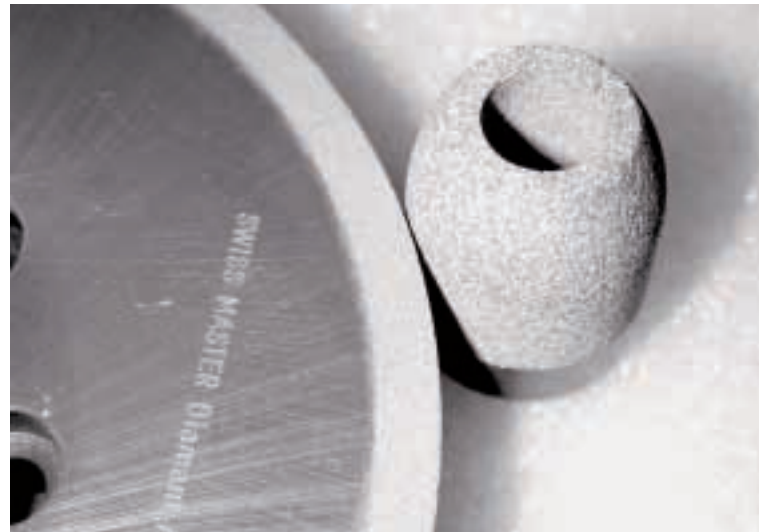
Keramisch gebundene Vit-DIA-Abbrichtwerkzeug und Vit-CBN-Schleifkörper (schematische Anordnung).
